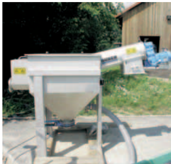
Mekanisk förening MiniCop, lämplig för HUBER BioMem®
