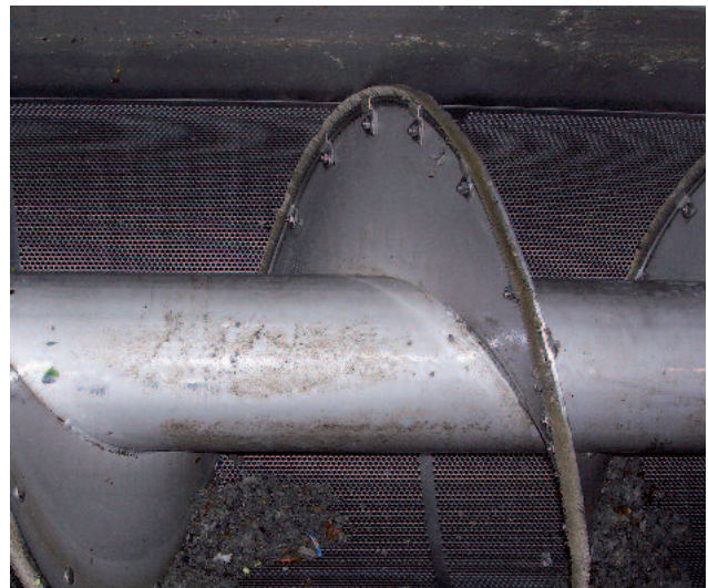
Skonsam automatisk rengöring av den halvrunda perforerade plåten
