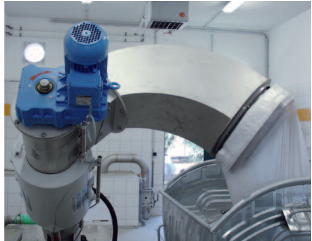
Individuellt anpassad installation med sidomonterad rengodsutmatning direkt i en container
