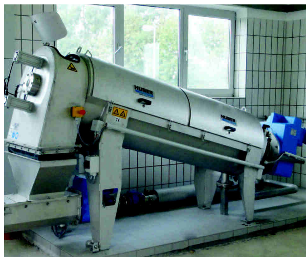
Stationär skruvpress för 180 kg/TS h
