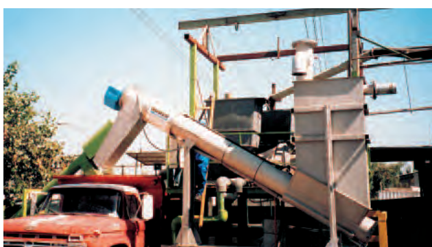
Slakteri Carnes Darc / Chile: ROTAMAT® Gödselpress Ro 7a, genomflöde: upp till 90 djurkroppar per timma
