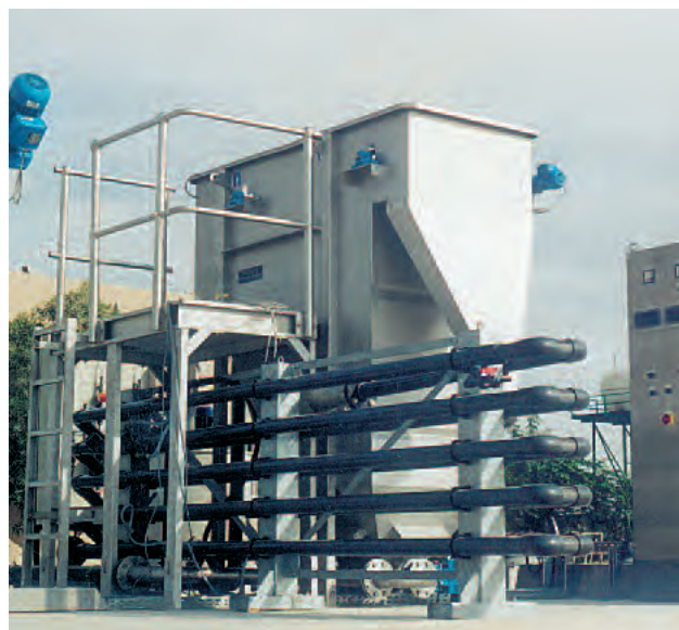
Slakteri Medinat Zaved / Förenade Arabemiraten: ROTAMAT® Skruvsil Ro9, HUBER Flotationsanläggning HDF-1, genomflöde: 10 m 3 /h
