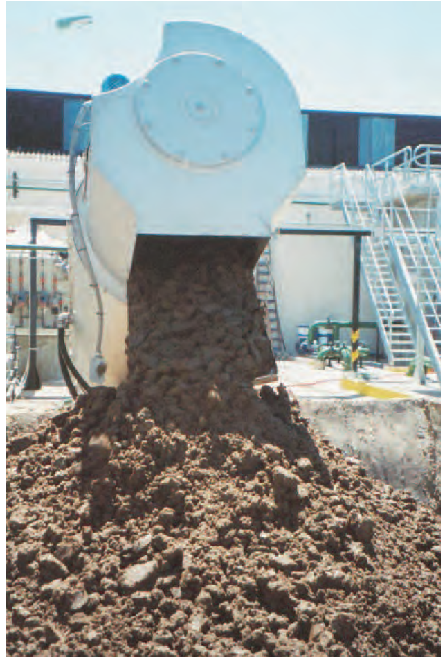
PEPSICO / Argentina: livsmedelsbehandling, utmatning från ROTAMAT® Skruvpress RoS 3, slutlig TS: 25 - 30 %
