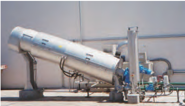
PEPSICO / Argentina: livsmedelsbehandling, ROTAMAT® Skruvpress RoS 3, genomflöde: 5 - 10 m 3 /h
