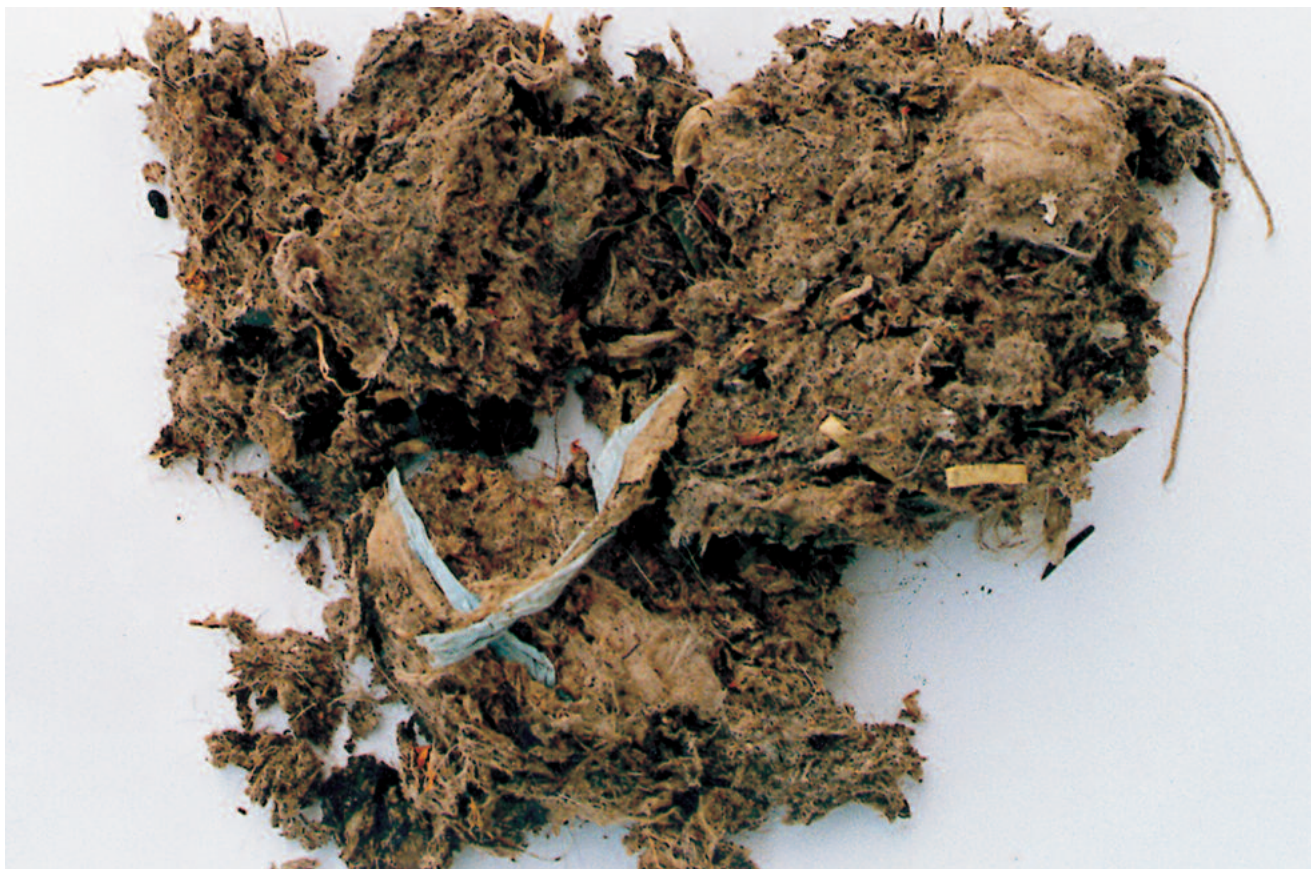
Separerat rensmaterial: trä, plast, aluminiumfolie, gummi, textilier, fibrer, hår etc.
