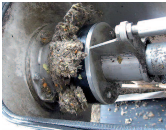
Utmatning av det separerade och pressade rensset
