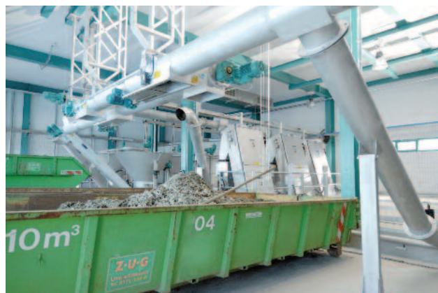
HUBER ROTAMAT® skruvtransportör Ro 8 matar ut rengods
