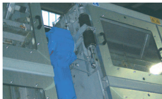
Ett kontrolloberoende säkerhetssystem (momentvakt) skyddar silen mot skador genom att ge en elektrisk signal. Den specifika designprincipen säkerställer hög justerbarhet och kontinuerlig kontroll.
