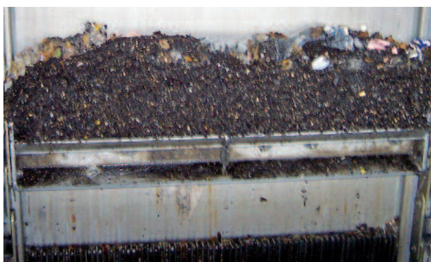
Silar med mindre spaltvidd (här 6 mm) har speciellt formade spalter (droppformiga). Tryckförlusten är markant minskad jämfört med platta eller trapetsformiga spalter. Den speciella spaltformen förhindrar igensättning av fasta partiklar i spaltmellanrummen. Silen bevisar sin okänslighet mot sand och grus.
